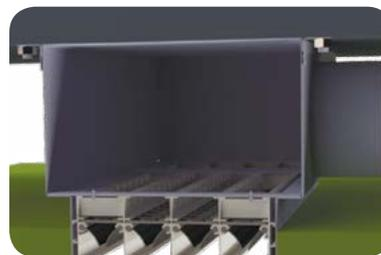
В случае монтажа непрерывной конструкции, необходимо устанавливать в места соединения выравнивающие пластины – коннекторы (поставляются в комплекте с составными секциями). Коннекторы крепятся с помощью заклепок 4х6.
