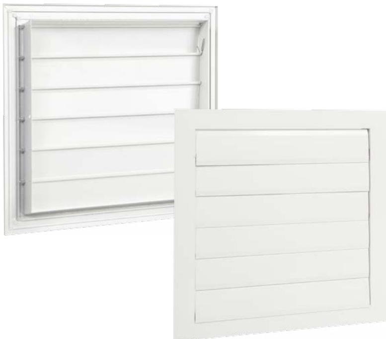
**Описание.** Решетка IG выполняет функцию обратного клапана, выпуская воздух, но предотвращая попадание его обратно. Устанавливается на фасад или воздуховод. При включении вентилятора лопатки решетки открываются под напором воздуха, при выключении лопатки приходят в исходное закрытое положение, тем самым предотвращая попадание осадков, листьев и живности в помещение или воздуховод.
